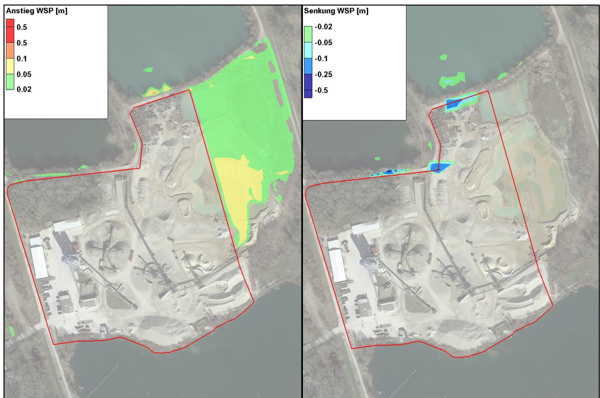
Abbildung 4-3: Differenzen der Wasserspiegellagen, Planungszustand minus Istzustand; Anstiege links, Senkungen rechts; Einblenden des BPlan-Umgriffs; Hintergrund: Luftbild © ESRI
